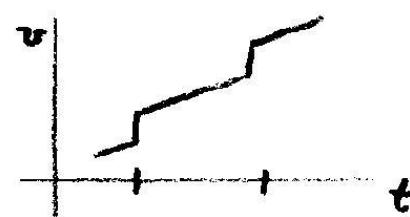
$$\text{Prinzip der Impulserhaltung: } m(t)v(t) = [m(t)-dm]v(t+\epsilon) + dm[v(t+\epsilon)-u]$$
