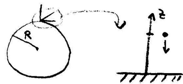
$$\boxed{\ddot{z} = -g, \quad \dot{z}(0) = 0, \quad z(0) = h} \quad (1D, 2 \text{ Anfangsdaten } \checkmark)$$
