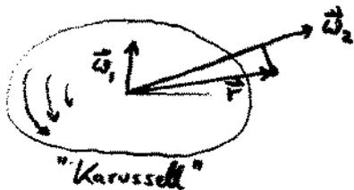
ohne Motor:  $\vec{a} = \vec{\omega}_1 \times \vec{r}$
