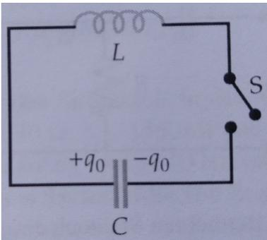
Berechne die Ladung  $q$  und den Strom  $I$  als Funktion der Zeit und skizziere diese Kurven. Zeige, dass der Strom der Ladung um  $90^\circ$  vorausseilt. (Bemerke, dass die Differentialgleichung  $d^2X/dt^2 + KX = 0$  die folgende Lösung hat:  $X(t) = X_0 \cos(\sqrt{K}t + \delta)$ .)
