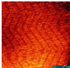
Abbildung: Gold mit Herringbone Struktur
