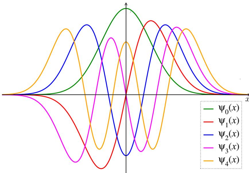
**Abbildung IV.4** – Wellenfunktionen (IV.33b) der fünf niedrigsten Energieniveaus des eindimensionalen harmonischen Oszillators.
