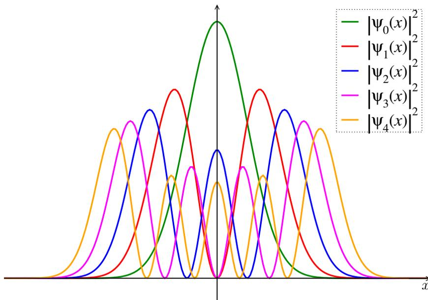
**Abbildung IV.5** – Aufenthaltswahrscheinlichkeiten für die fünf niedrigsten Energieniveaus des eindimensionalen harmonischen Oszillators.
