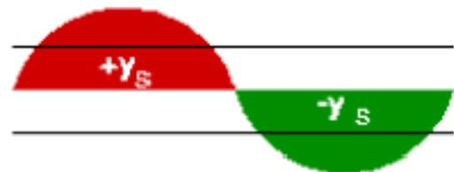
Abb. 10: Wellenquerschnitt mit den Abständen  $y_s$  der Schwerpunkte der beiden halbkreisförmigen Wellenhälften.
