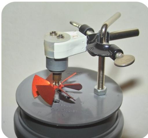
Abb. 41: Die ausströmende Luft trifft durch die Bohrlöcher direkt auf die Rotorblätter des montierten Generators.
