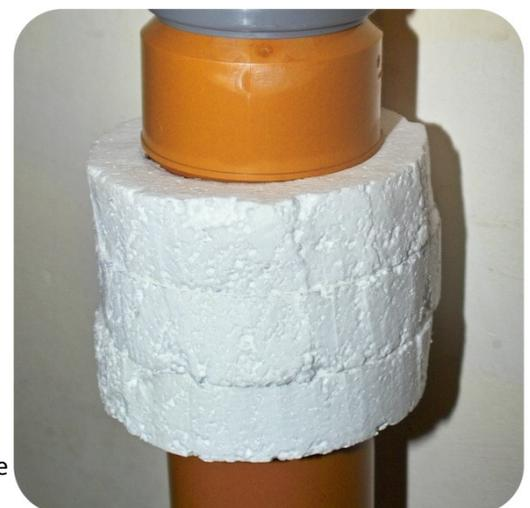
Abbildung 42 zeigt die Montage der Schwimmkörper am Rohr B. Die Anzahl der Ringe hängt davon ab, wie viel Auftrieb die Konstruktion benötigt, um an der Wasseroberfläche zu schwimmen und sich mit den Wellen zu bewegen.
