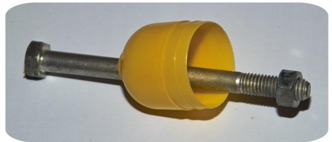
Abb. 46: Die Schraube wird durch das Loch im Ei gesteckt. Anschließend wird die Mutter aufgeschraubt.
