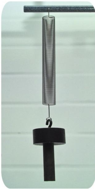
Das Massestück wird an einer Seite der Feder und diese später mit dem anderen Ende an der Gewindestange befestigt. Der Stabmagnet wird mit einem Ende von unten an das Massestück gehängt. Der genaue Aufbau ist in der nebenstehenden Abbildung zu erkennen.
