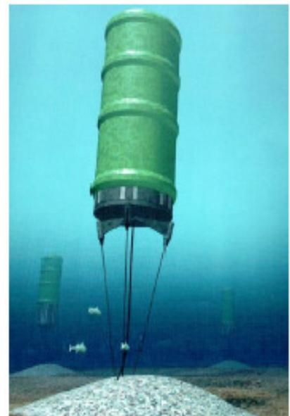
Linearmotoren wandeln diese Relativbewegung gegenüber einem ruhenden Zylinder im Inneren in elektrische Energie um. Abbildung 44 zeigt die Anlage in einer Animation.
