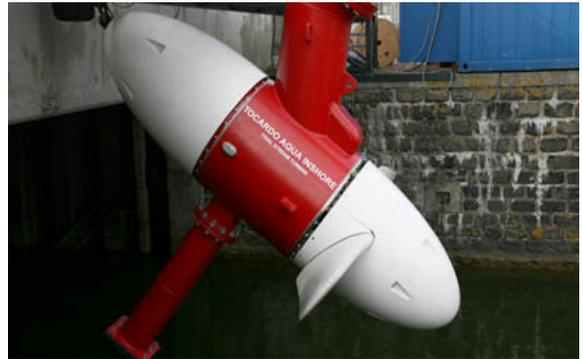
Abb. 35: Der Tocardo funktioniert wie die Strömungsanlage und wird in den Küstenschutz integriert.
