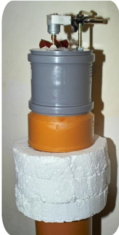
Die gesamte äußere Konstruktion besteht nun aus dem großen Rohr B, dem Reduzierstück, dem kleineren Rohr C und dem Deckel mit dem montierten Generator. Die nebenstehende Abbildung zeigt den oberen Teil dieser äußeren Konstruktion.
