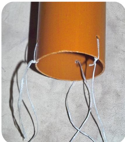
In dieses Rohr werden nahe des unteren Randes drei Löcher gebohrt, durch die das Seil zur Befestigung der Anlage am Stein gezogen werden kann. Die drei Löcher sollten gleichmäßig über den Rand des Rohres verteilt liegen, damit die Boje später möglichst senkrecht im Wasser hängt und wenig Schräglage bekommt. Es sind mindestens drei Bohrungen nötig, da nur mit drei oder mehr Haltepunkten die Neigung korrigiert werden kann.
