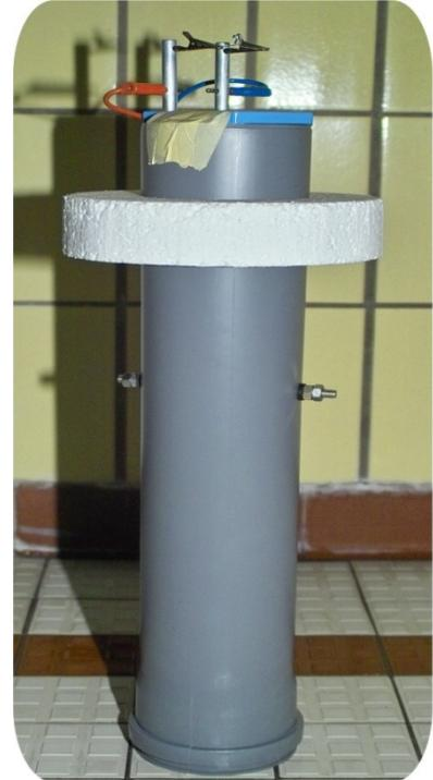
Abb. 54: Der Nachbau der Brandl-Generator-Boje in seiner endgültigen Form.
