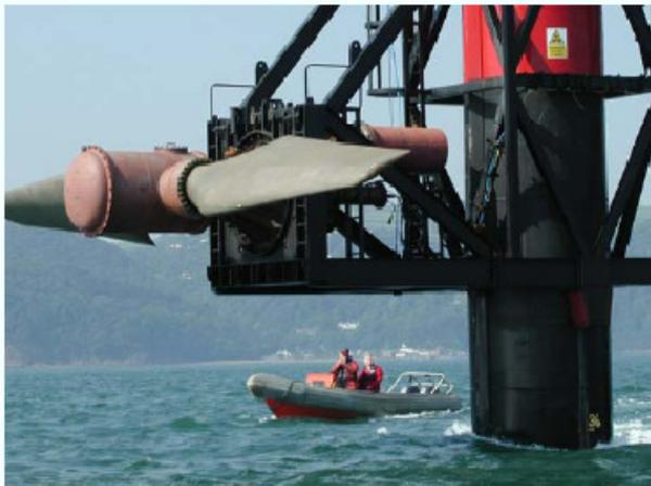
Abb. 33: Der SeaFlow zur Nutzung der Meeresströmung ähnelt einem Windrad.
